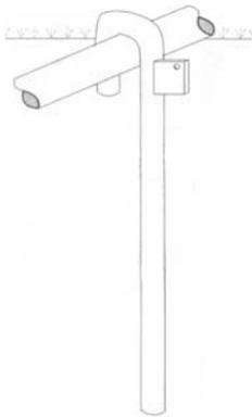
Ce type d'ancre peut être utilisé quand le cadre au sol du but de football ne présente pas d'ouvertures faites au préalable. Le sommet courbé de la perche est placé par-dessus le cadre au sol. L'ouverture du crochet doit être adaptée au diamètre du poteau. Les perches doivent être enfoncées le plus profondément possible dans le sol. Les perches présentant un diamètre plus grand et/ou une surface rude résistent à des forces plus grandes.
