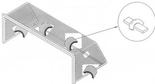
Des sacs de sable (ou autres contrepoids) peuvent être utilisés si le but de football est installé sur une surface dure. Le nombre de sacs de sable nécessaire varie en fonction du poids et des dimensions du but de football.
