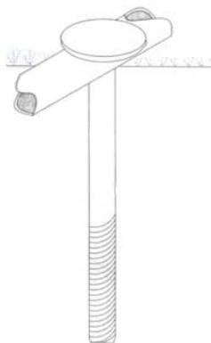
Ce type d'ancre peut être utilisé si des ouvertures ont été forées au préalable dans le cadre au sol du but de football.
